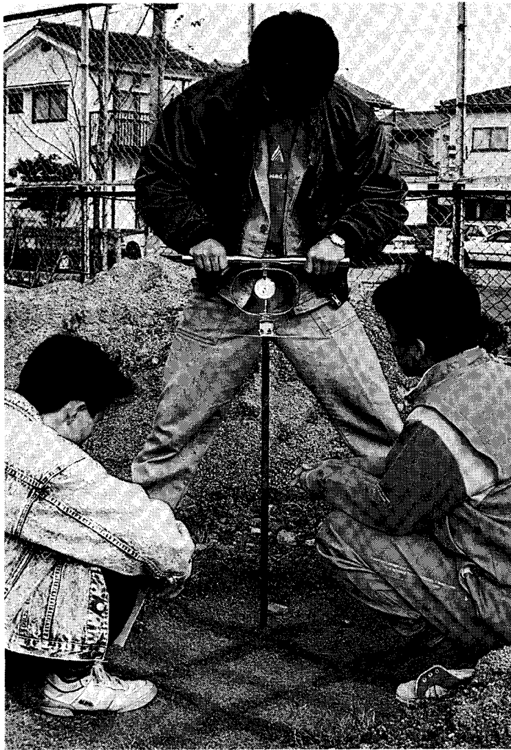
写真-1 簡易コーン貫入試験(単管)
