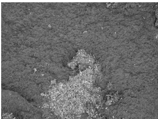
図3 表面の藻類被膜を採取後の砂層の状態
